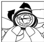
Insira a extremidade flexível da membrana na ranhura do revestimento do aro. Para melhor efectuar esta operação deve iniciá-la tendo o aro posicionado para cima do lado legível do diafragma.
