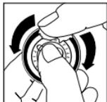
Com a ponta de um dedo, deve colocar uma pequena quantidade de pó de talco na superfície interior da membrana. Isto irá facilitar a montagem e manter uma alternância sem problemas entre as altas e baixas frequências. Deve bater na membrana com os seus dedos para remover o excesso de pó de talco.
