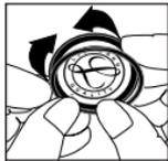
Insira a extremidade flexível da membrana na ranhura do revestimento do aro. Para efectuar melhor esta operação, deve iniciá-la tendo o aro posicionado para cima do lado ligevel do diafragma.
