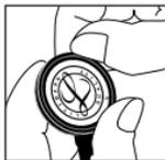
Inspeccione a extremidade onde o diafragma encaixa no aro para um ajuste uniforme. Ajustes ligeiros podem ser efectuados, puxando e fazendo rodar ligeiramente o aro para fora da membrana, permitindo que este mantenha a posição correcta.
