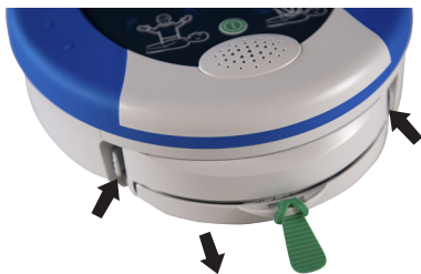
Figura 8. Retirar o Pad-Pak
