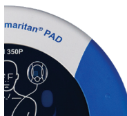
Figura 12. Nenhuma luz indicadora de estado; Ver Resolução de problemas no Anexo B.
